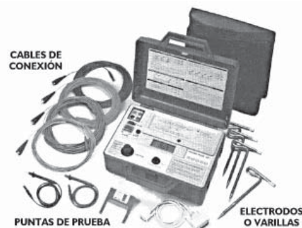
Fig. 2.4 Megger Instrumento utilizado para medir la condición de los aislamientos.
