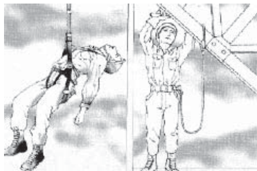
Fig. 17 Condiciones que ha de reunir el cinturón de seguridad
