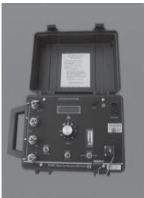
Fig. 2.5 Instrumento para medir resistencia de contactos y medición de malla de tierras.
