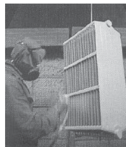
Fig. 1.40 Transformador en proceso de pintado
