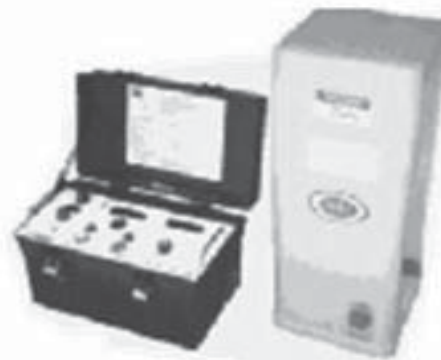
Fig. 2.41 HYPOT, Equipo para pruebas dieléctricas en C.D. hasta 120 Kv para verificar la calidad del aislamiento eléctrico de cables de potencia, tableros, aisladores, interruptores, contactores de potencia, etc.
