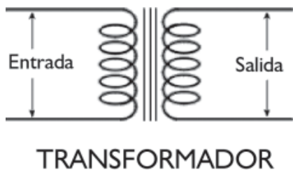
Fig. 1.18 Estructura de un transformador monofásico
